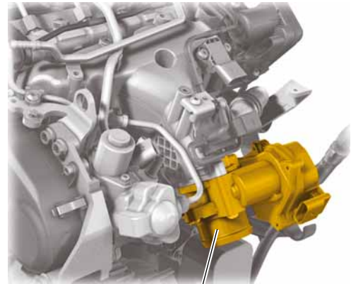
Drosselklappensteuereinheit J338 mit Drosselklappenpotenziometer G69
